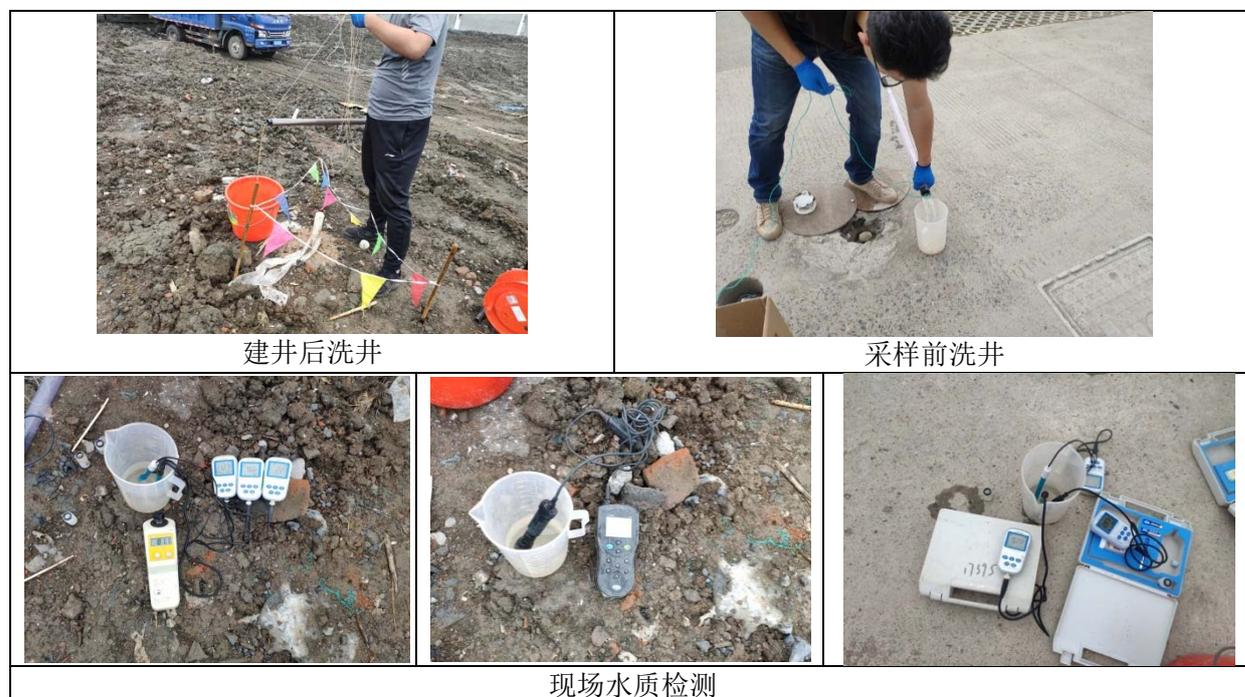
图 5.2-4 地下水洗井和现场检测照片
